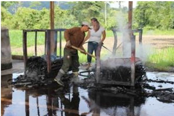
Após ser queimado em um forno por 5 horas, os bambus usados para produzir biocarvão são resfriados com água...
